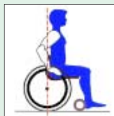
Die Sitzereinheit hat zwar eine gute Form, ist aber nicht gut im Verhältnis zu den Antriebsrädern angebracht, die zu weit hinter den Schultern sind.
